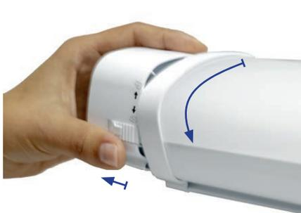
Mit dem Drehfix-Bajonettverschluss geht alles ganz schnell und einfach. Stirnseite mit den Anschlüssen ineinanderstecken und mit entgegengesetztem Drehen verbinden. Ein seitlicher Klick-Riegel sichert zusätzlich.
