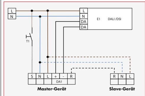
**Angeschlossene Slave-Geräte müssen die gleiche Phase wie das Master-Gerät haben.**
