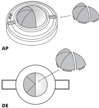
Falls der Erfassungsbereich des Melders zu groß ist oder Bereiche abdeckt, welche nicht überwacht werden sollen, kann mit den beiliegenden Lamellen (Blinds) der Bereich nach Bedarf reduziert bzw. eingeschränkt werden.
