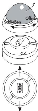
Der Melder muss auf eine ebene, feste Unterlage montiert werden. Vor der Montage muss die Linse entfernt werden. Dazu ist die Linse (C) gegen den Uhrzeigersinn um ca. 5° zu drehen und abzunehmen. Nach dem vorschriftsmäßigen Anschluss der Leitungen ist der Melder mit 2 Schrauben zu befestigen und die Linse durch Drehen im Uhrzeigersinn wieder aufzustecken. Netzspannung zuschalten.
